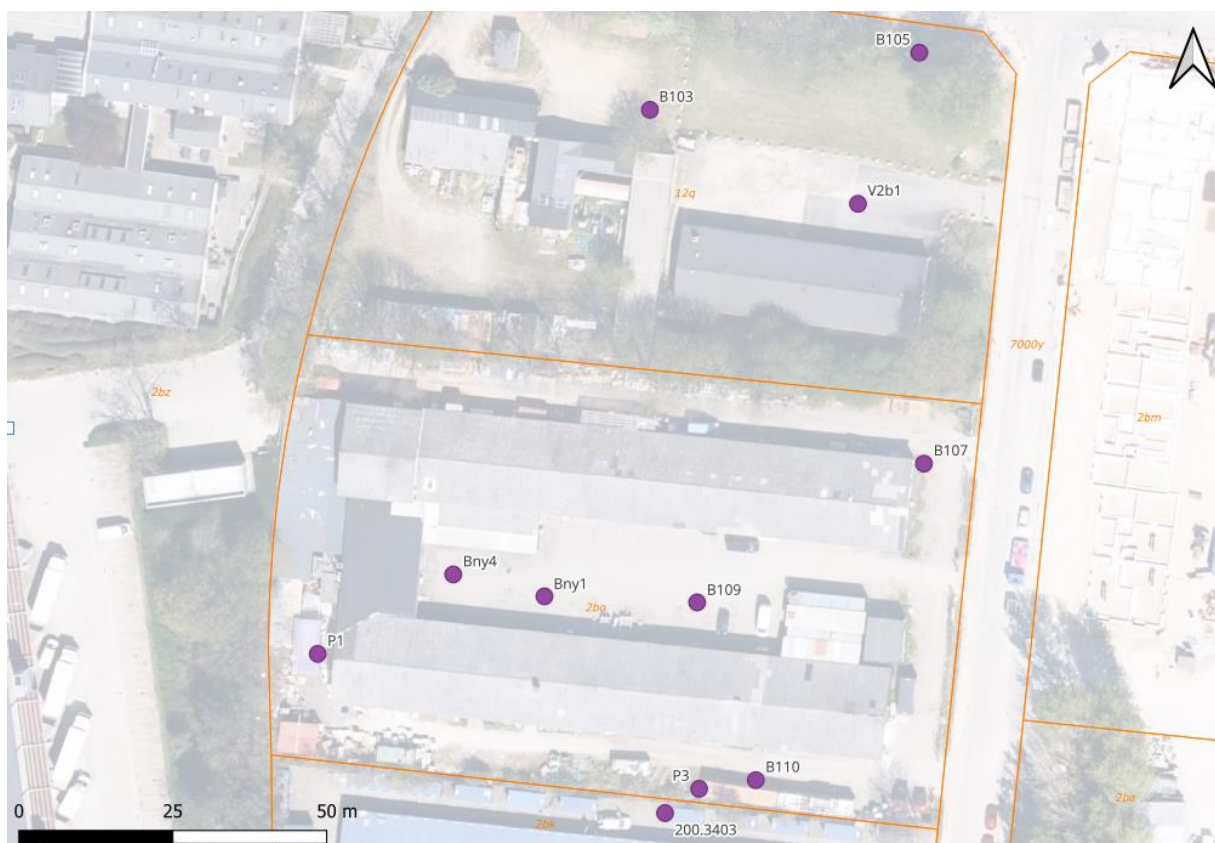
Figur 3.1: Placering af eksisterende filtersatte boringer i arbejdsområdet, der blev pejlet ved pejlerunden opsummeret i Tabel 1. Boringerne er markeret med lilla cirkler. Alle boringer er filtersat i øvre kvartære aflejringer med undtagelse af amtsboringen med DGU nr. 200.3403.
