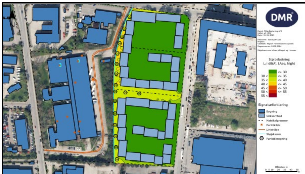
Figur 18: © GeoDanmark 2024. Vejledende støjkort i hverdage om natten mellem kl. 22 - 07, med støjskærmning omkring udvalgte støjkilder, samt i terræn. Der skal tages udgangspunkt i tallene og farven inde i tallene.
