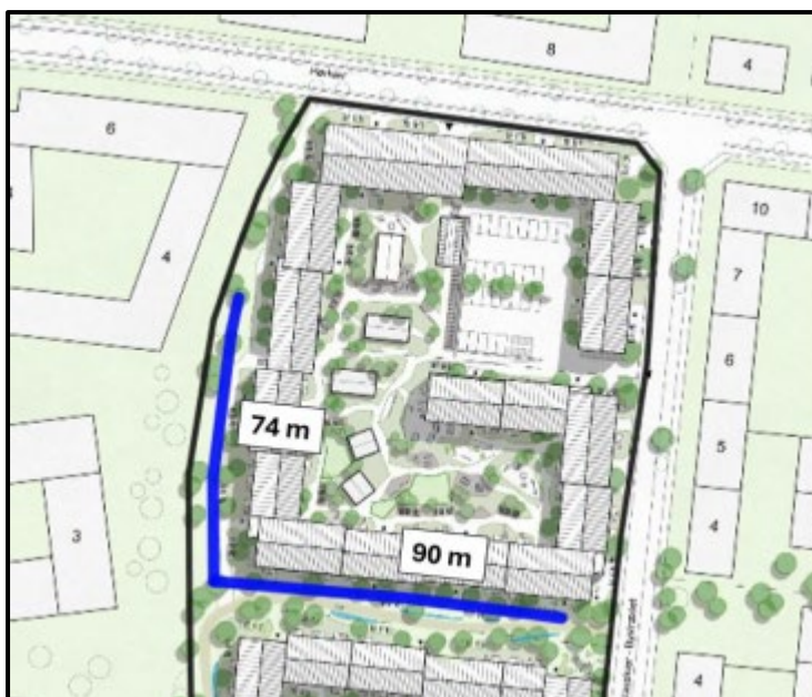
Figur 11: Visualisering af placering af V-formet grøftesystem for Vasekær 2-4.
